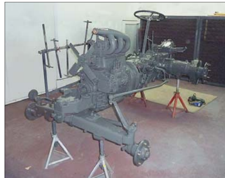
Wie frisch aus dem Werk: Erst nachdem der Untergrund sorgsam vorbereitet war, brachte der Lackierer den Decklack auf
