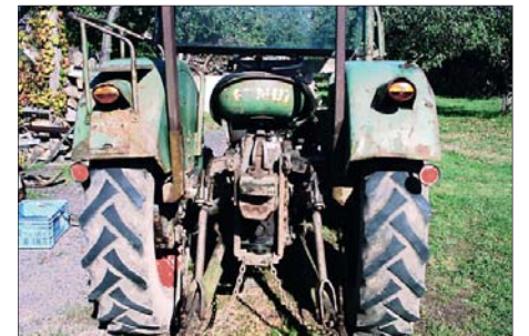
Knapper Schutz: Das Verdeck verhinderte zwar ein direktes Beregnen des Hecks, dennoch fand die Korrosion ihren Weg
