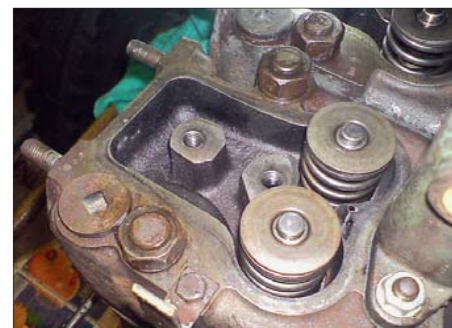
Gar nicht übel: Unter den Ventildeckeln sah es nach der gründlichen Reinigung auf den ersten Blick recht ordentlich aus
