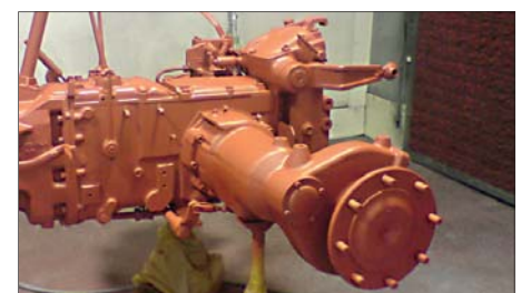
Solider Lackaufbau: Eine gut haftende Grundierung war die Basis für den Fendt-typischen grauen Decklack des Rumpfes
