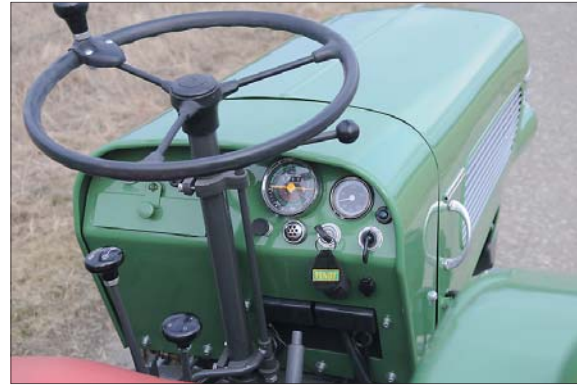
Einfach und logisch: Ein Schalthebel fürs Vorgelege und einer für die Gänge
