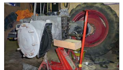
Tropfnass: Da sich nach dem Strahlen noch Ölnester an der Hydraulik zeigten, musste Winfried Horn das Heck neu abdichten
