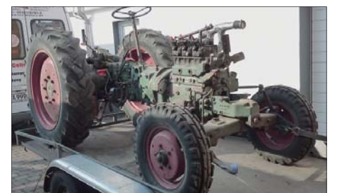
Auf zum Blankmachen: Der technisch restaurierte Schlepper rollt mit sorgfältig verschlossenen Öffnungen zum Strahlen
