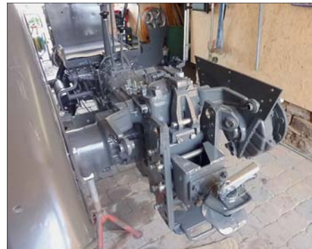
Nacharbeit verhindern: Vor der Lackierung montierte der Besitzer den Grundschepper und passte alle Blechteile sorgfältig an
