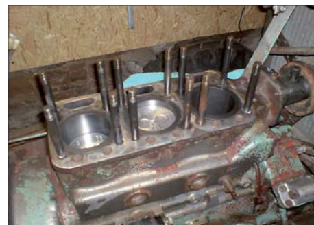
Rost hatte die sonst leicht herausnehmbaren Laufbuchsen regelrecht im Motorblock festgeschweißt, hier sind es bereits die neuen
